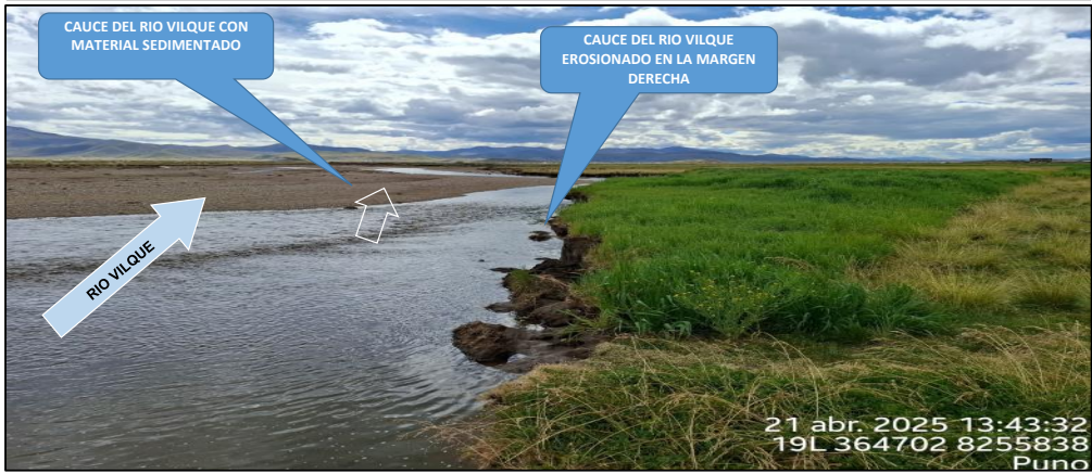
FIGURA 02 : TRAMO CRÍTICO EN EL RÍO VILQUE, NÓTESE, LA ACUMULACION DE MATERIAL SEDIMENTADO EN EL CAUCE, QUE REQUIERE SER ELIMINADO PARA REESTABLECER LA SECCION HIDRAULICA DE LA CAJA DEL CAUCE EN ESTE SECTOR.
